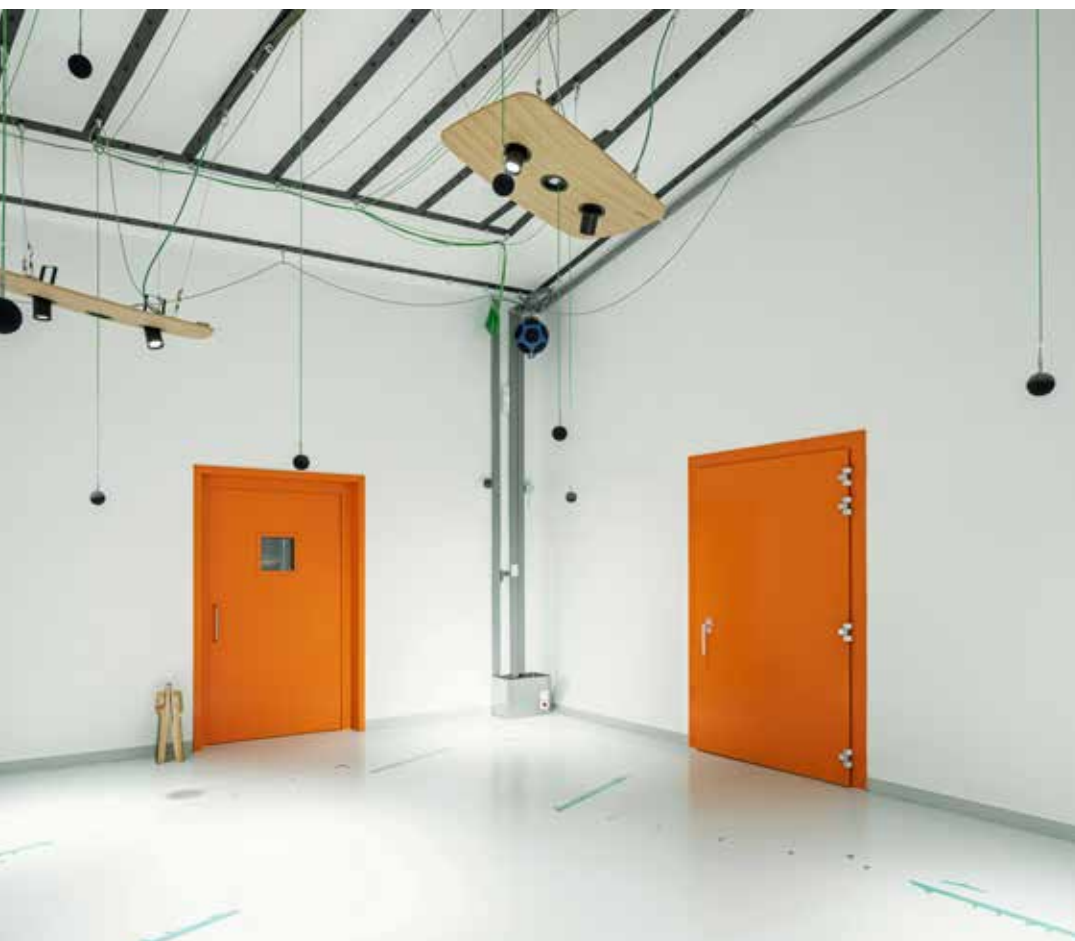
La camera riverberante. Dedicata alla misurazione allo studio dei materiali fonoassorbenti, è in grado di riprodurre il riverbero di una cattedrale. Le perfette funzionalità sono garantite dalla geometria costruttiva a pareti asimmetriche e dalla struttura dell'involucro cementizio. A destra, Giorgio e Franco Caimi in uno dei sette laboratori dell'azienda. ● The reverberation room, for measuring and studying sound-absorbing materials, can recreate the echoes produced in a cathedral. Perfect functionality is guaranteed by the geometry of the asymmetrical walls and the structure of the concrete enclosure. Right, Giorgio and Franco Caimi in one of the company's seven laboratories.
